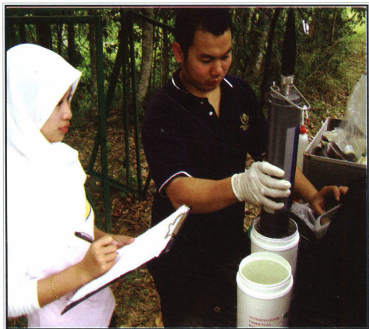
Gambar 2.3: Kerja-kerja pengukuran in-situ bagi persampelan telaga air bawah tanah yang di lakukan di lapangan dengan menggunakan alat Multi Parameter Sonde.
