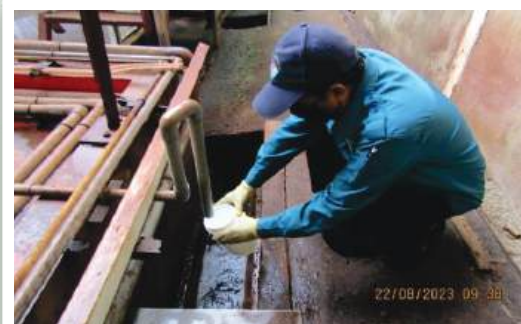
Kerja - kerja Persampelan Efluen Terolah Sistem Pengolahan Efluen Perindustrian (SPEP) di Takat Pelepasan Akhir di Premis.
