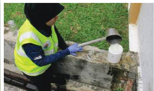
Pegawai sedang mengambil Persampelan Efluen Terolah Sistem Pengolahan Efluen Perindustrian (SPEP).
