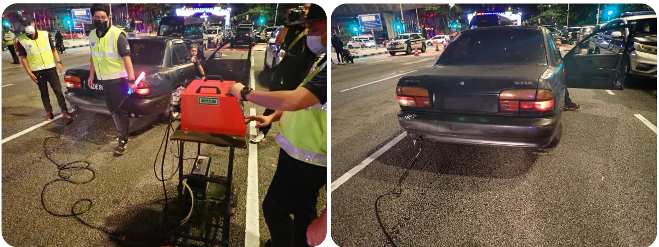
Gambarfoto 3.24: Operasi Pelepasan Gas CO/HC daripada Kenderaan Berenjin Petrol
