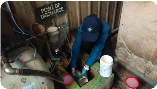
Gambarfoto 3.6: Persampelan Efluen Perindustrian di Bawah Peraturan-Peraturan Kualiti Alam Sekeliling (Efluen Perindustrian) 2009
