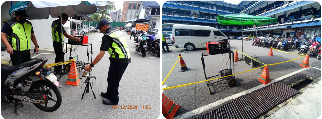
Gambarfoto 3.26: Operasi Pelepasan Gas CO daripada Motosikal
