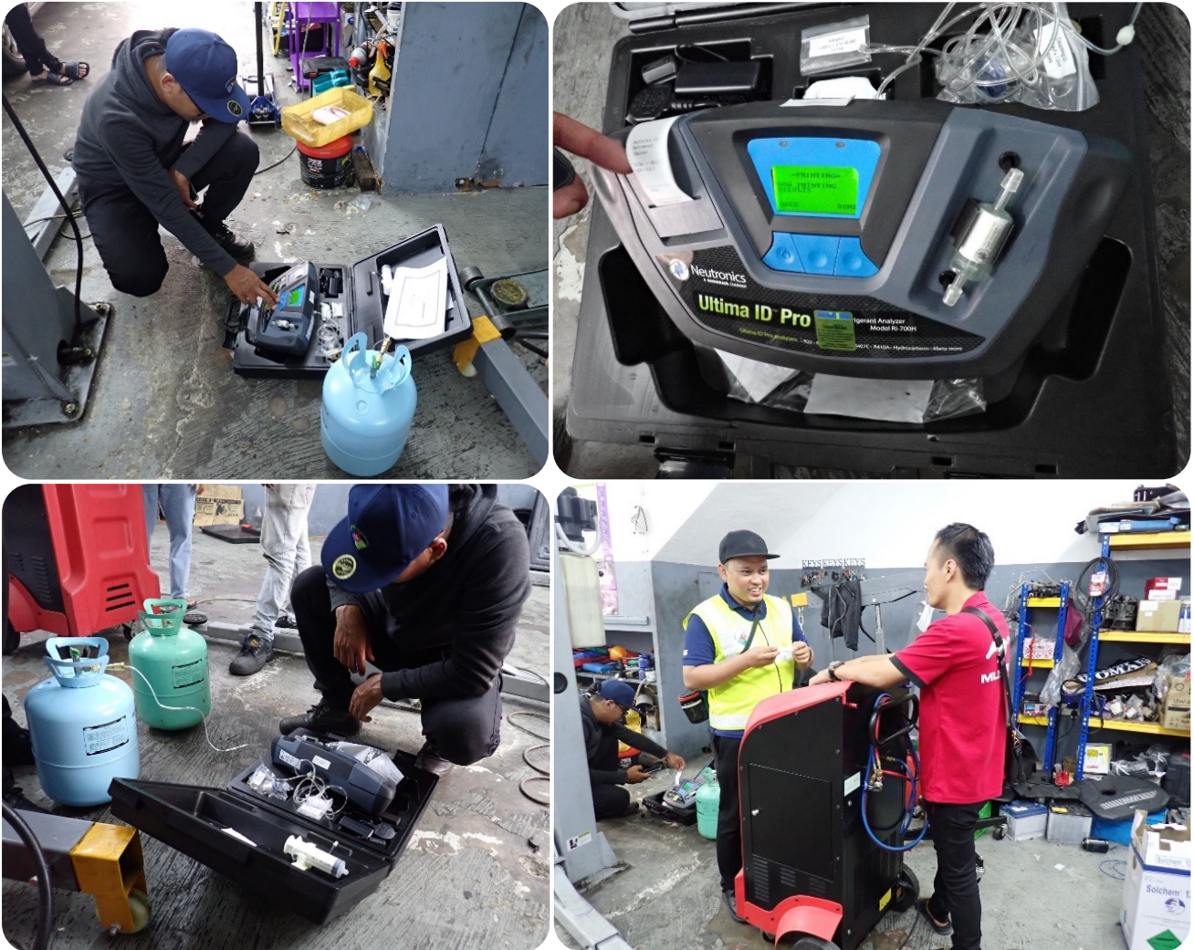
Gambarfoto 3.23: Pemeriksaan Pematuhan dan Pengujian dengan Menggunakan Refrigerant Identifier
