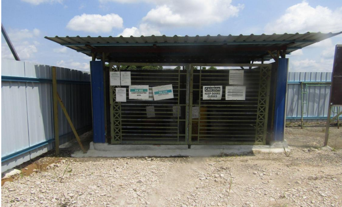
Rajah 2.14: Pengurusan buangan terjadual yang baik dengan membina stor yang berbumbung dan berpagar
