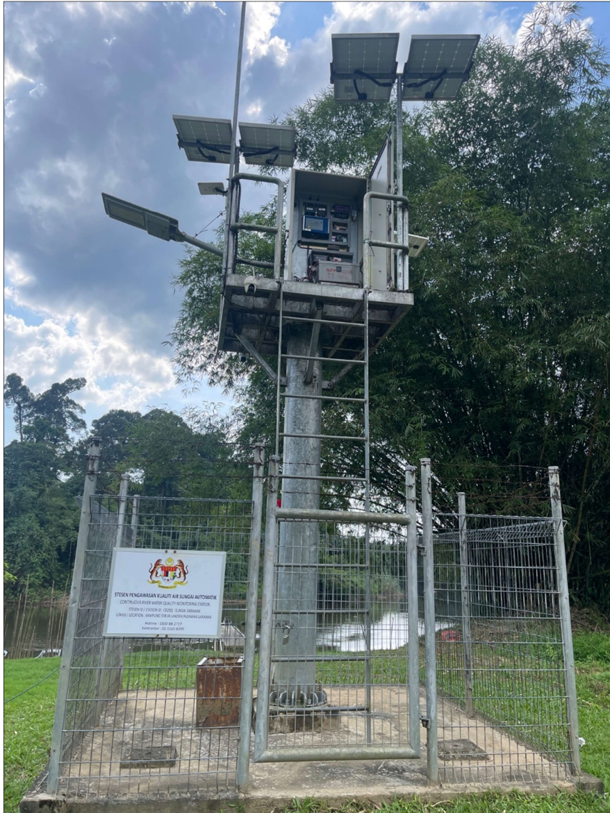
Foto 4.5: Stesen pengawasan kualiti air sungai automatik (CRWQM) yang terletak di Sungai Sarawak Kiri
