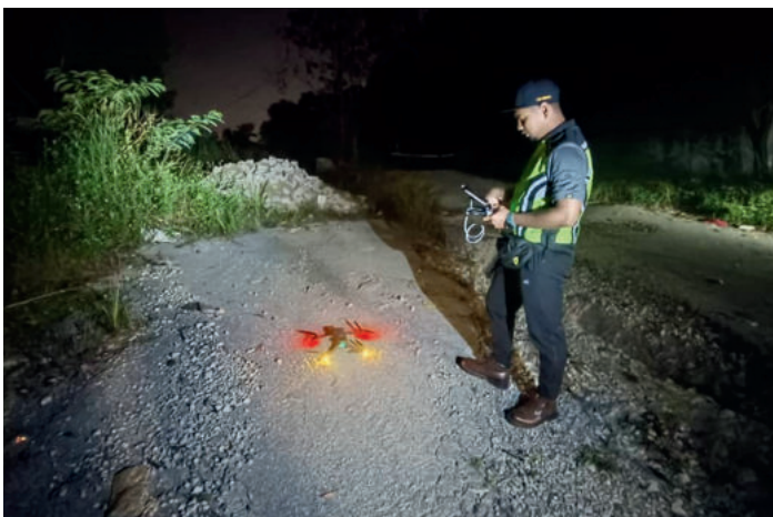
Foto 4.23: Pemantauan aerial di kawasan tanah gambut terbakar menggunakan teknologi thermal drone. Titik merah menunjukkan kawasan yang masih mempunyai nyalaan & baraan api
