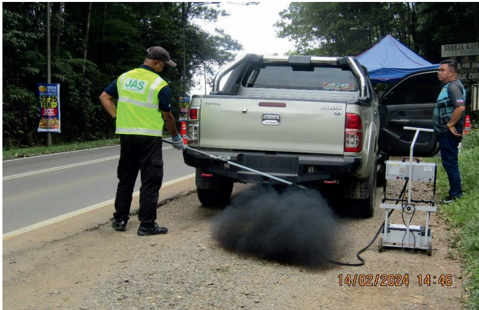
Gambar 6.1: Ujian asap hitam dijalankan ke atas kenderaan Diesel semasa operasi statik dijalankan
