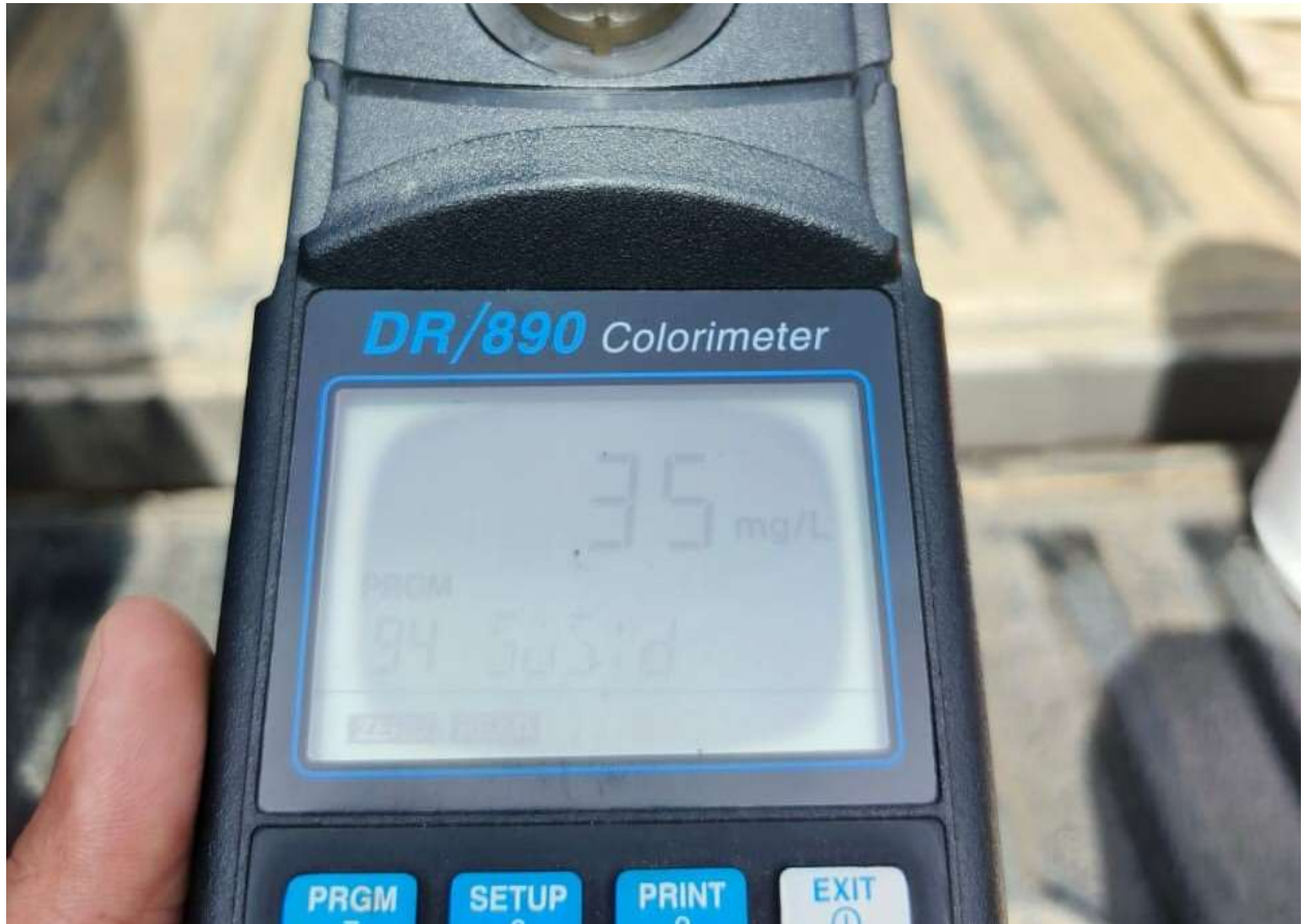
Gambar 3: Ujian in-situ air anak Sungai Rumlak dengan menggunakan alat Hach DR/890 Colorimeter mendapati bacaan bagi parameter pepejal terampai adalah 35 mg/l.
