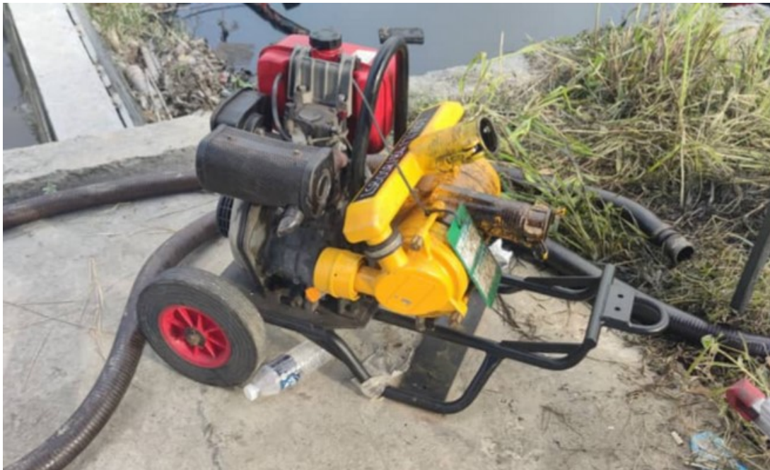
Gambar 27 - 29: Operasi pengepaman air dicemari buangan terjadual daripada kolam takungan banjir ke tangki lori
