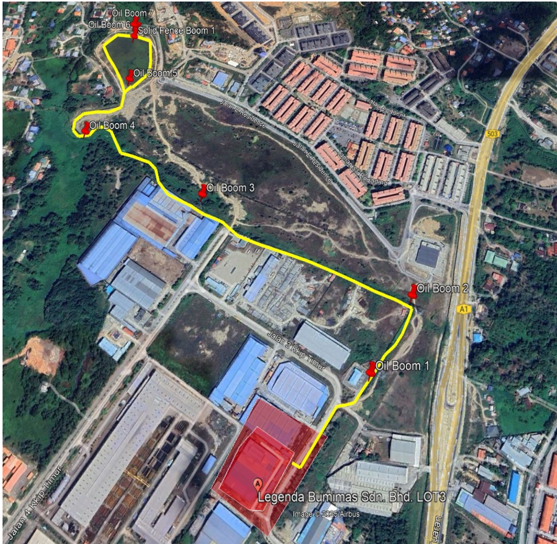
Gambar 24 : Lokasi pemasangan oil boom di sepanjang aliran yang tercemar (kuning) dan kawasan larangan akses oleh pihak BOMBA. (merah)
