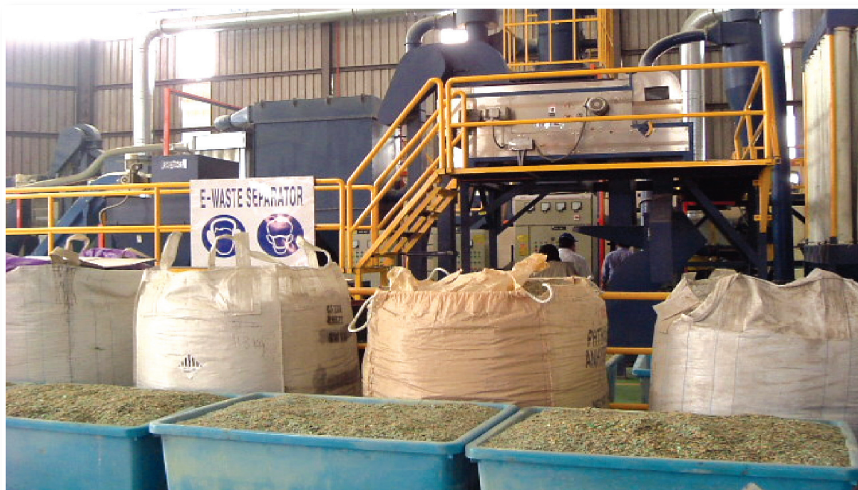
Mesin Pemisah Buangan Elektronik (E-Waste) E-Waste Separator Machine
