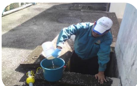
Aktiviti Percontohan "Grab Sampling" di Takat Pelepasan Akhir Loji Indah Water Konsortium (IWK)
