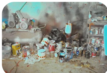
Penstoran Buangan Terjadual yang Tidak Mengikut Prosedur yang Ditetapkan
