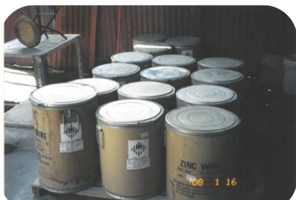
Penstoran Buangan Terjadual yang Tersusun di Tempat Tertutup, Dalam Bekas yang Sesuai dan Berlabel
