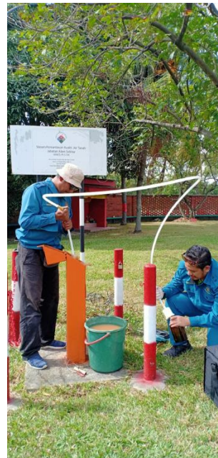
Gambar 5.5 : Pengukuran kedalaman “water column” bagi kerja persampelan air tanah.
