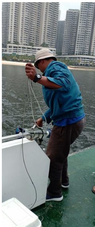
Gambar 5.7 : Pengambilan sampel air marin untuk analisis kimia di makmal dengan menggunakan alat persampelan air Van Dorn bagi stesen manual.
