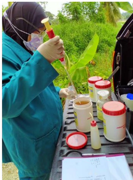
Gambar 9.1: Persampelan air sungai bagi mengenalpasti punca pencemaran
