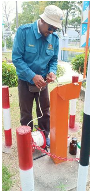
Gambar 5.5 : Pengukuran kedalaman “water column” bagi kerja persampelan air tanah.
