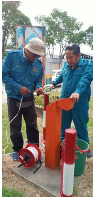
Gambar 5.5 : Pengukuran kedalaman “water column” bagi kerja persampelan air tanah.
