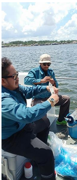
Gambar 5.7 : Pengambilan sampel air marin untuk analisis kimia di makmal dengan menggunakan alat persampelan air Van Dorn bagi stesen manual.
