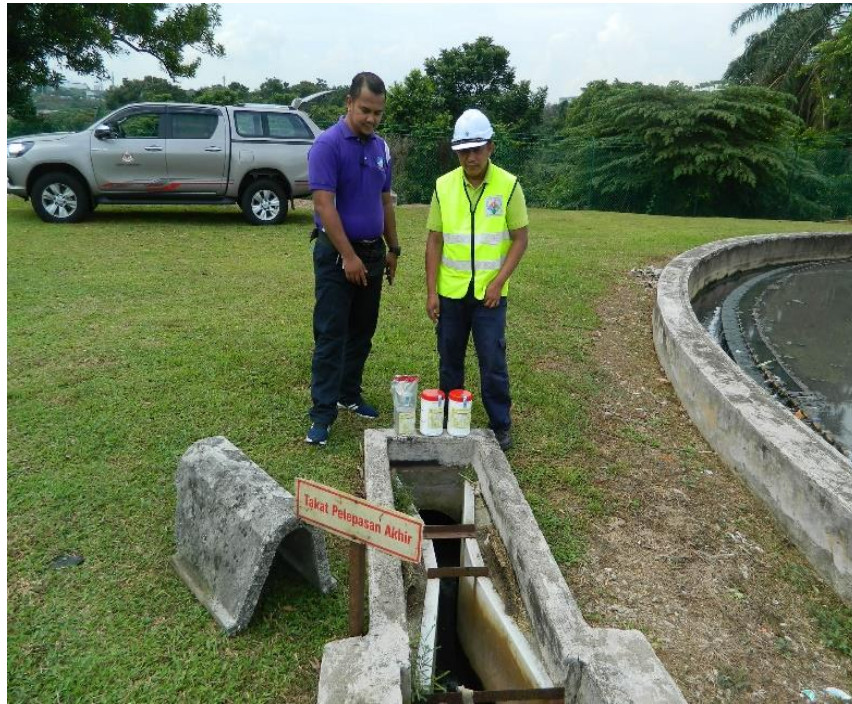
Gambar 9.9 : Persampelan yang dijalankan di takat pelepasan akhir di loji pengolahan kumbahan
