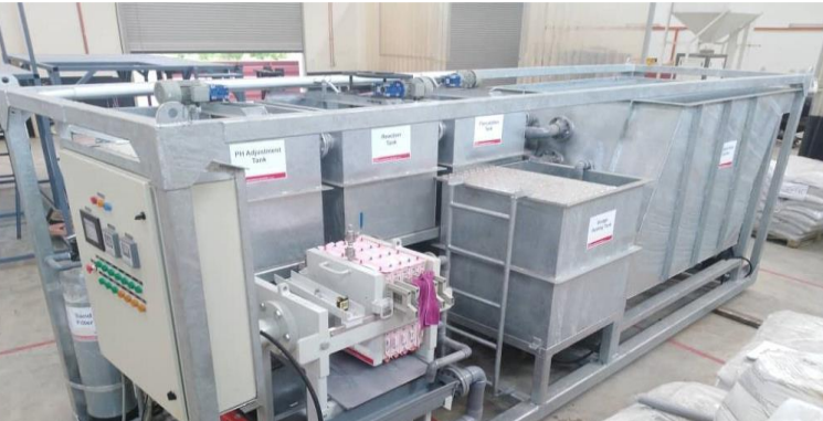
Rangkaian rawatan: penyamaan → pelarasan pH → tindak balas BIO-DFA + PAC → penjernih → kolam kitaran semula
