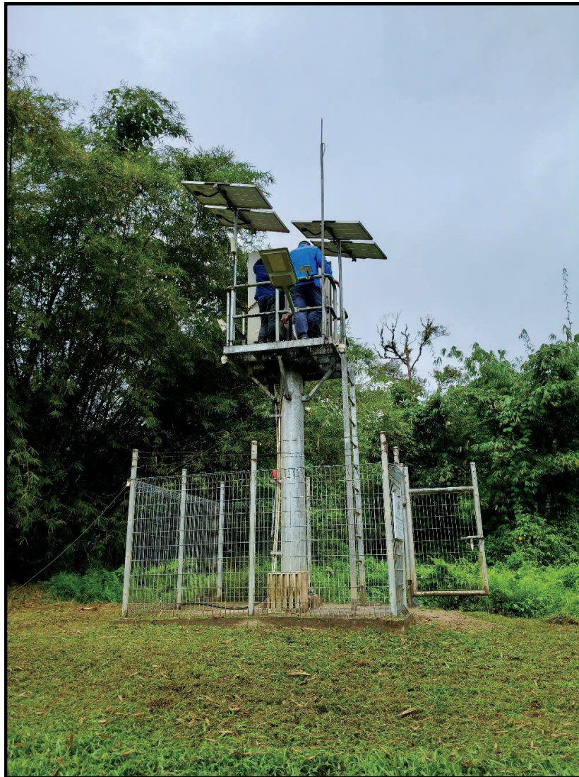
Foto 4.10 : Stesen pengawasan kualiti air sungai automatik (CRWQM) yang terletak di Sungai Sarawak Kiri
